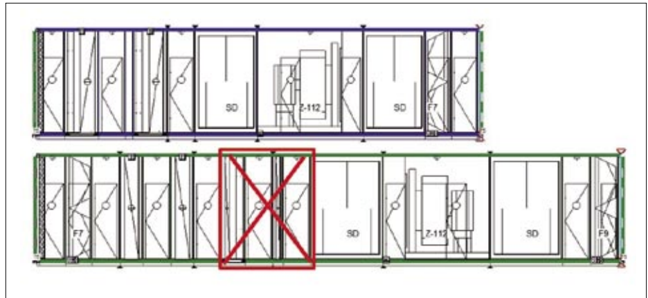
Baulängen von Zentrallüftungsgeräten: Der geringe Platzbedarf mehrfachfunktionaler Systeme (oben) fällt besonders bei Sanierungsmaßnahmen ins Gewicht.
